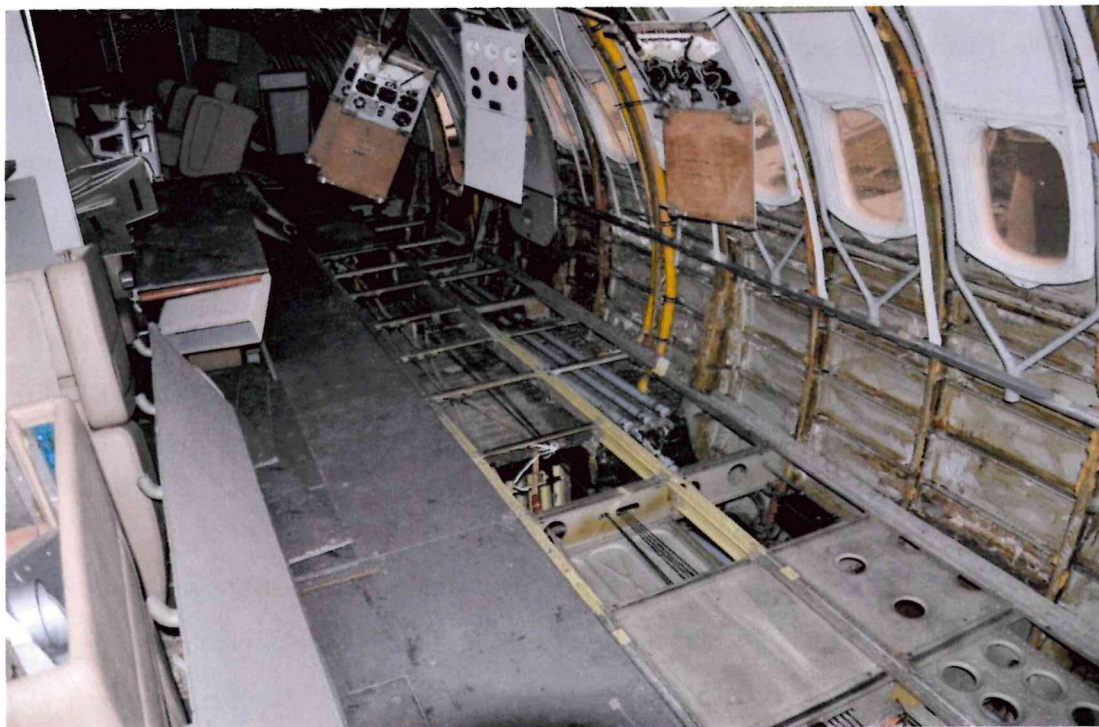
Rys. 4.7. Zdemontowana podłoga, fotele oraz elementy tapicerki i izolacji ściany bocznej w kabinie pasażerskiej
