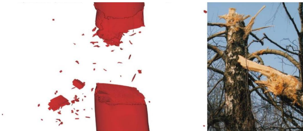
Rys. 3.35 Analiza zderzenia z drzewem - uszkodzenie drzewa widok Nr 2
