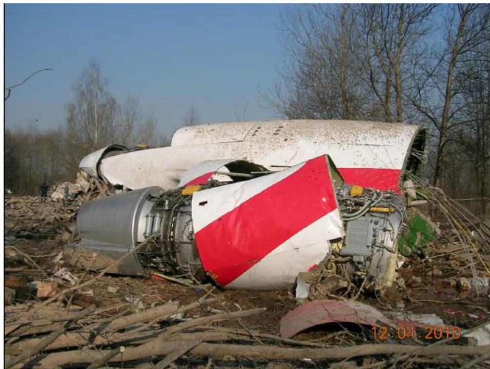
Rys. 1.17 Uszkodzone mocowanie silnika [ 1 ]
