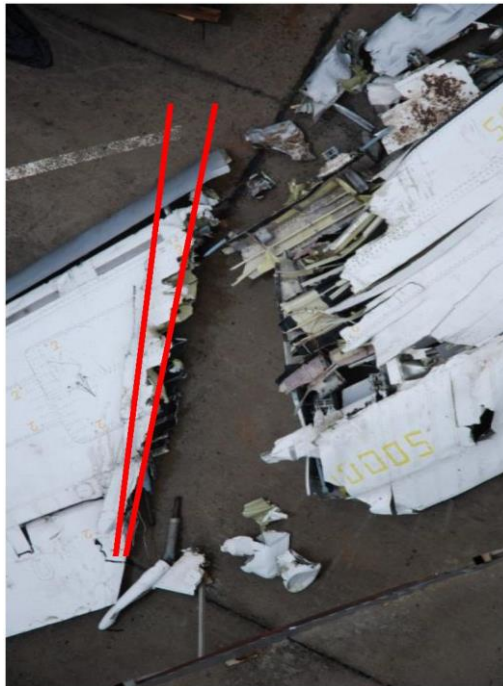
Rys. 3.27 Porównanie uszkodzeń urwanego skrzydła ze zdjęciami szczątków dostarczonymi przez Polską Podkomisję [20]
