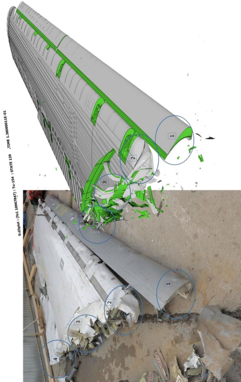
Rys. 3.18 Uszkodzenia urwanego skrzydła - widok z góry (w 138 ms)
